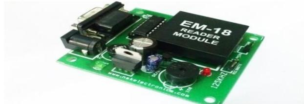
Fig 5-. RFID tag reader
