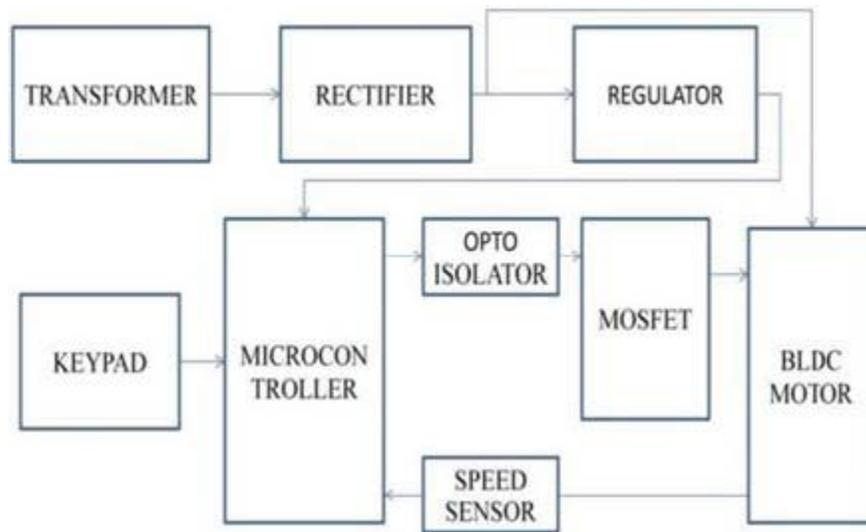
Fig .4 : Block Diagram
